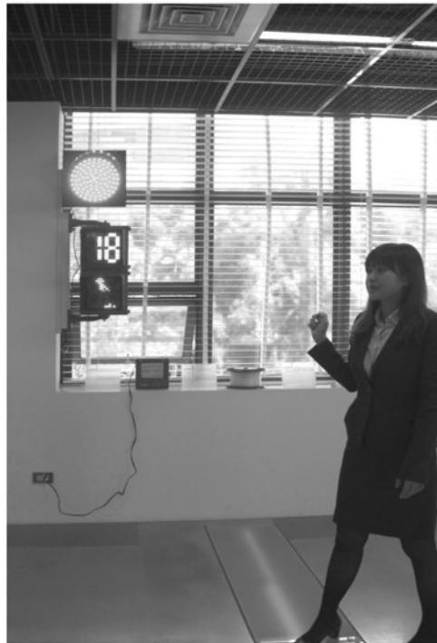
新竹科学工業圏区 展示施設内のカウンタダウンする信号機
