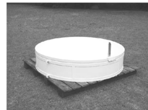
大型蒸発計の例(口径120cm)
