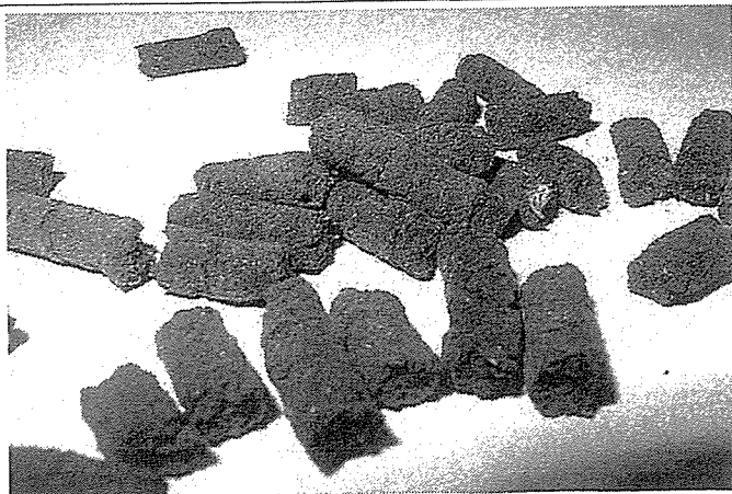
新技術を使って作り出した乾燥汚泥。バイオマス燃料としても利用可能だ
