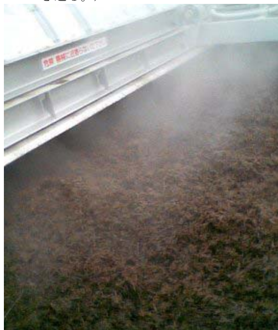
図2 連続式攪拌設備(レーン全長：約 85m 幅：4.5m。奥側から手前側に走行。一度の走行で、1.2m分の堆肥を奥側へ掻き送る。)
