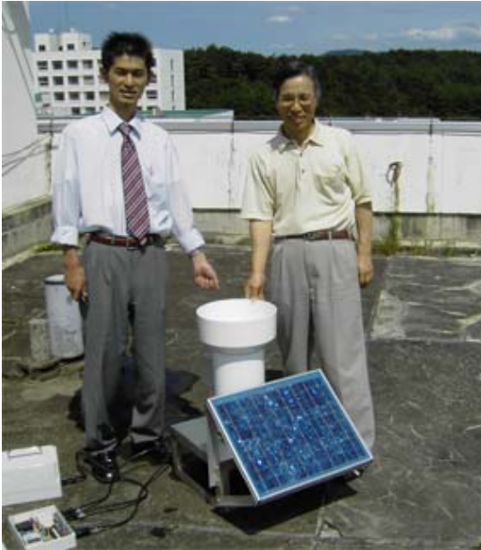
屋上に設置された降雨強度計
